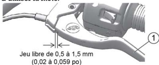
2. Le jeu est la portée du mouvement de la position de repos au point de résistance du câble. Le jeu du levier d'embrayage devrait se situer entre 0,5 et 1,5 mm. Mesurer l'écart entre le levier d'embrayage et son boîtier. Consulter la page 84. Régler le jeu du levier d'embrayage si nécessaire.
