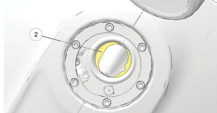
2. Insérer la pompe à carburant dans le col de remplissage du réservoir.
