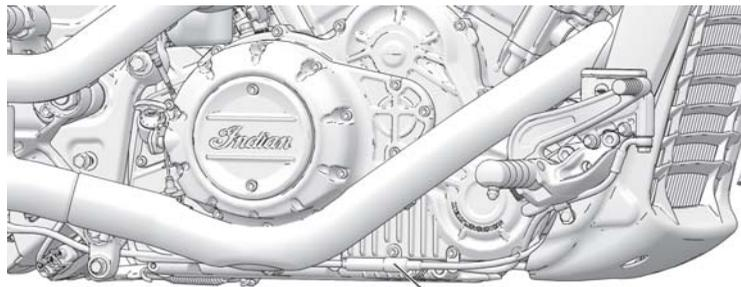
2. Tout en tenant le câble, tourner le dispositif de réglage du câble vers l'intérieur ou l'extérieur jusqu'à ce que le jeu du levier d'embrayage soit de 0,5 à 1,5 mm.
